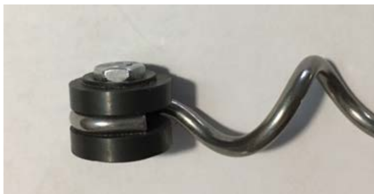
Рис. 3. Устройство роторного магнитного смесителя (PMS)
