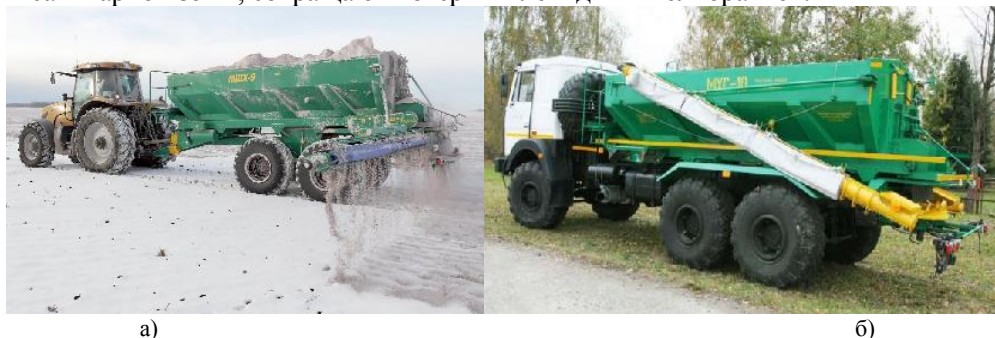
Рис. 1. Машины для внесения пылевидных химвелиорантов: а) прицепная машина МШХ-9, б) самоходная машина МХС-10
